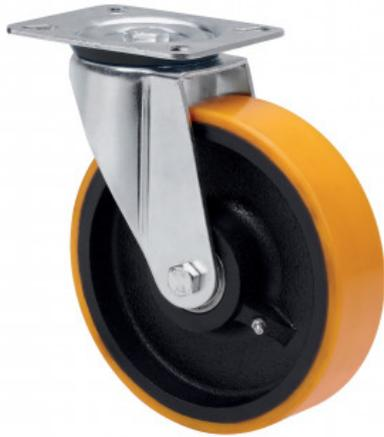
Roues série ZVR-HU, avec roulement en acier et bande de polyuréthane moulée avec une dureté de 95° shore A, spécialement indiqué pour supporter des charges élevées jusqu'à 700 kg.
