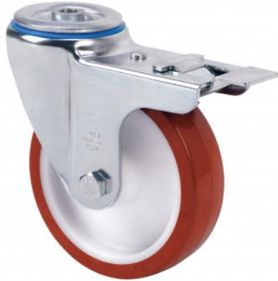
Roulettes à noyau en polypropylène blanc et bande en polyuréthane brun injecté d'une dureté de 95° shore A. Indiquées spécialement pour supporter des charges jusqu'à 300 kg.
