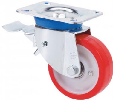
Roulettes à noyau blanc et bande de polyuréthane rouge duresté 90-95° shore A. Recommandées spécialement pour supporter de fortes charges jusqu'à 600 Kg.
