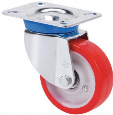
Roulettes à noyau blanc et bande de polyuréthane rouge duresité 90-95° shore A. Recommandées spécialement pour supporter de fortes charges jusqu'à 600 Kg.
