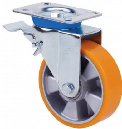
Roulettes à noyau en aluminium et bande en polyuréthane avec dureté 95° shore A. Indiquées spécialement pour supporter de fortes charges jusqu'à 800 kg.
