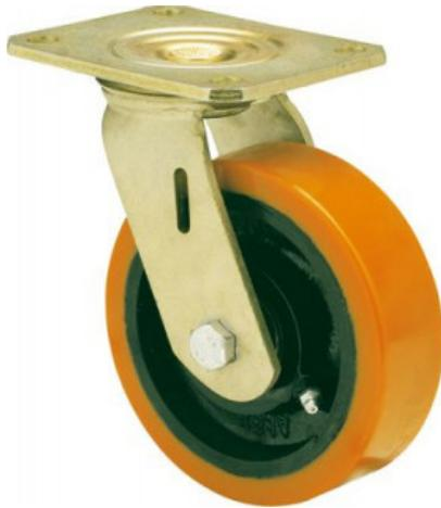
Roulettes à noyau central en acier et bande de polyuréthane fondu avec dureté de 95° shore A, spécialement recommandées pour supporter des poids lourds jusqu'à 600 Kg.
