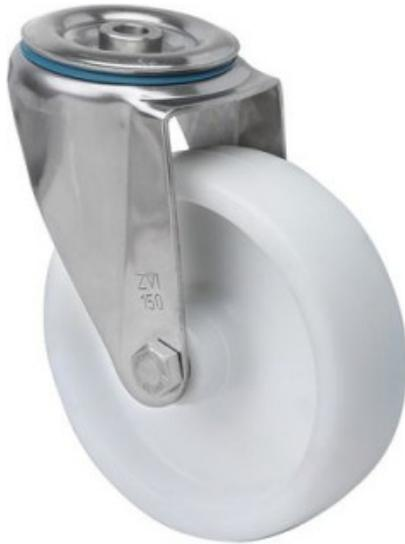
Roulettes en polypropylène blanc avec tous ses composants en acier inoxydable (AISI 304). Indiquées spécialement pour supporter des charges jusqu'à 400 kg.
