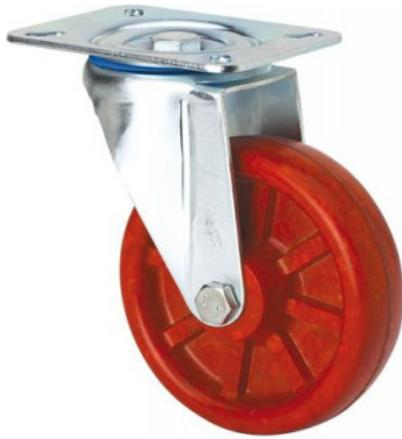
Roulettes en résine extraforte, indiquées spécialement pour résister à de fortes températures et à de fortes charges jusqu'à 600 Kg. Avec tous ses composants en acier inoxydable (AISI 304).
