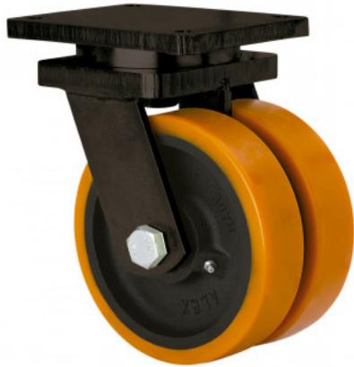
Roulette double à noyau en acier et bande de polyuréthane fondu avec dureté de 95° shore A, indiquées spécialement pour supporter de fortes charges jusqu'à 2 500 kg.
