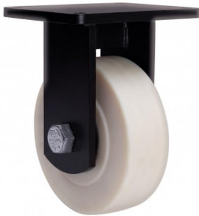
Roulettes en nylon fondu extrafort de fortes densités contre tous types d'agents chimiques et à l'usure due à l'abrasion. Indiquées spécialement pour supporter de très fortes charges jusqu'à 7 000 kg.
