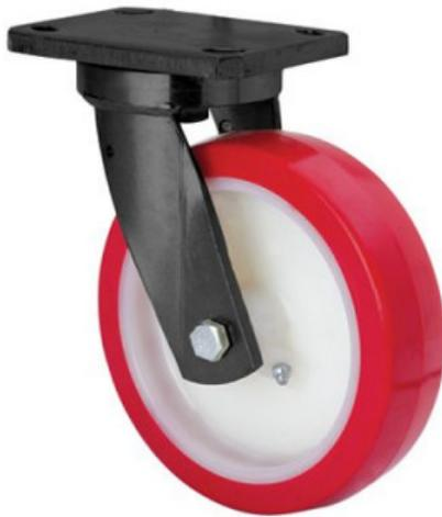
Roulettes à noyau en nylon blanc et bande de polyuréthane rouge durété 90-95° shore A. Traction mécanique. Indiquées spécialement pour supporter de fortes charges jusqu'à 600 kg.
