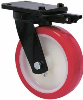
Roulettes à noyau en nylon blanc et bande de polyuréthane rouge dureté 90-95° shore A. Traction mécanique. Indiquées spécialement pour supporter de fortes charges jusqu'à 600 kg.
