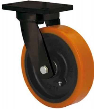
Roulettes à noyau en acier et bande de polyuréthane fondu avec une dureté 95° shore A, indiquées spécialement pour supporter de fortes charges jusqu'à 1900 kg.
